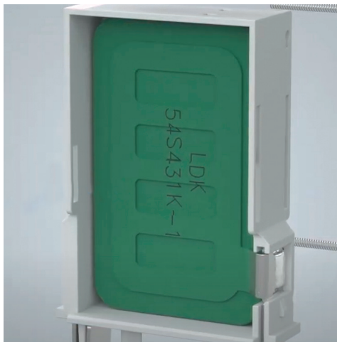
Высокомощный металлооксидный варистор
